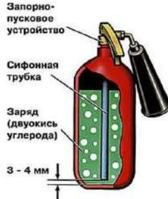
**ПРИНЦИП ДЕЙСТВИЯ** основан на вытеснении двуокиси углерода избыточным давлением. При открывании запорно-пускового устройства  $CO_2$  по сифонной трубке поступает к раструбу и из сжиженного состояния переходит в твердое (снегообразное). Температура резко (до  $-70^\circ C$ ) понижается. Углекислота, попадая на горящее вещество, изолирует его от кислорода
