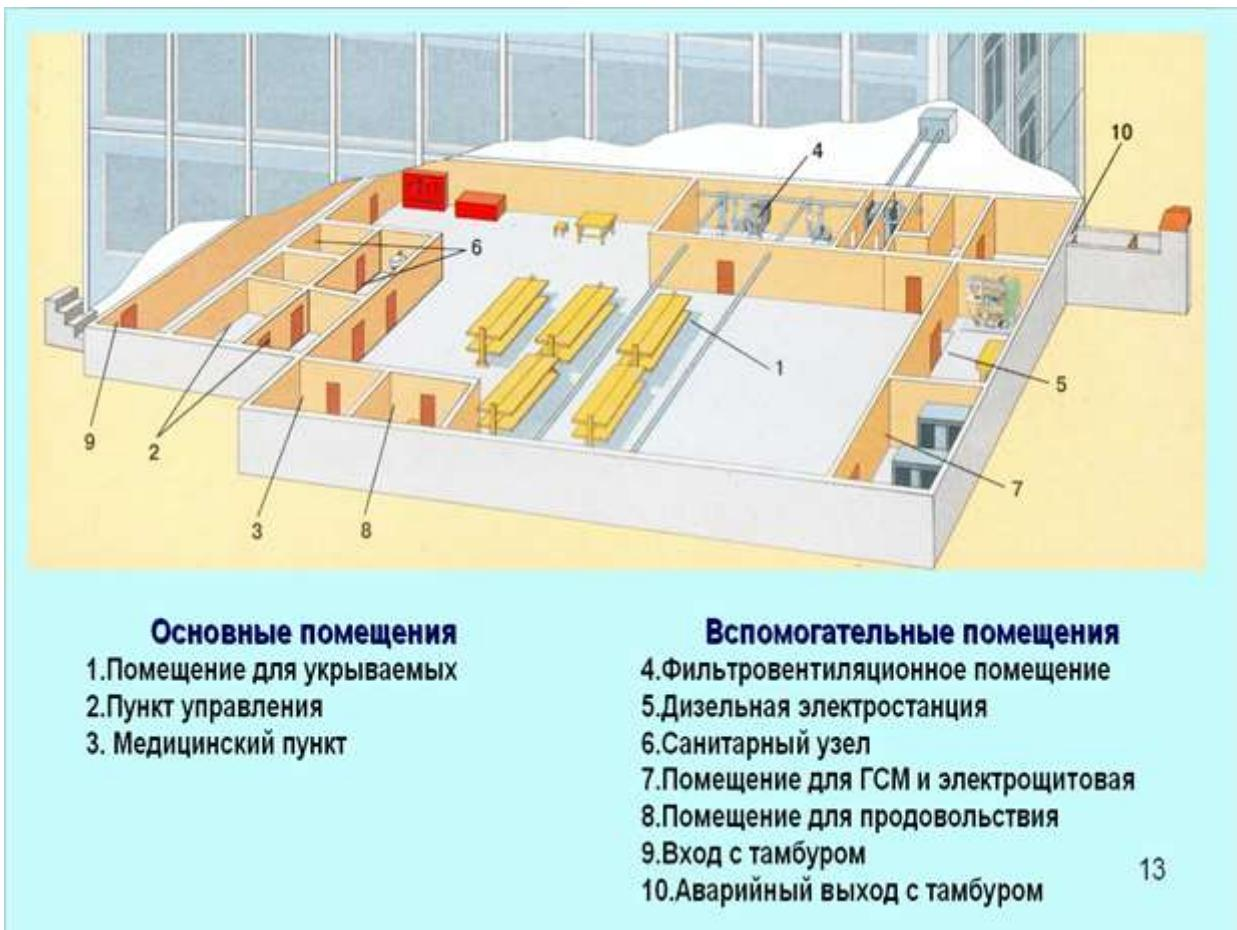
**Система воздухоснабжения** должна обеспечивать очистку наружного воздуха, требуемый его обмен; снабжение воздухом осуществляется с помощью фильтровентиляционных систем по трем режимам:
