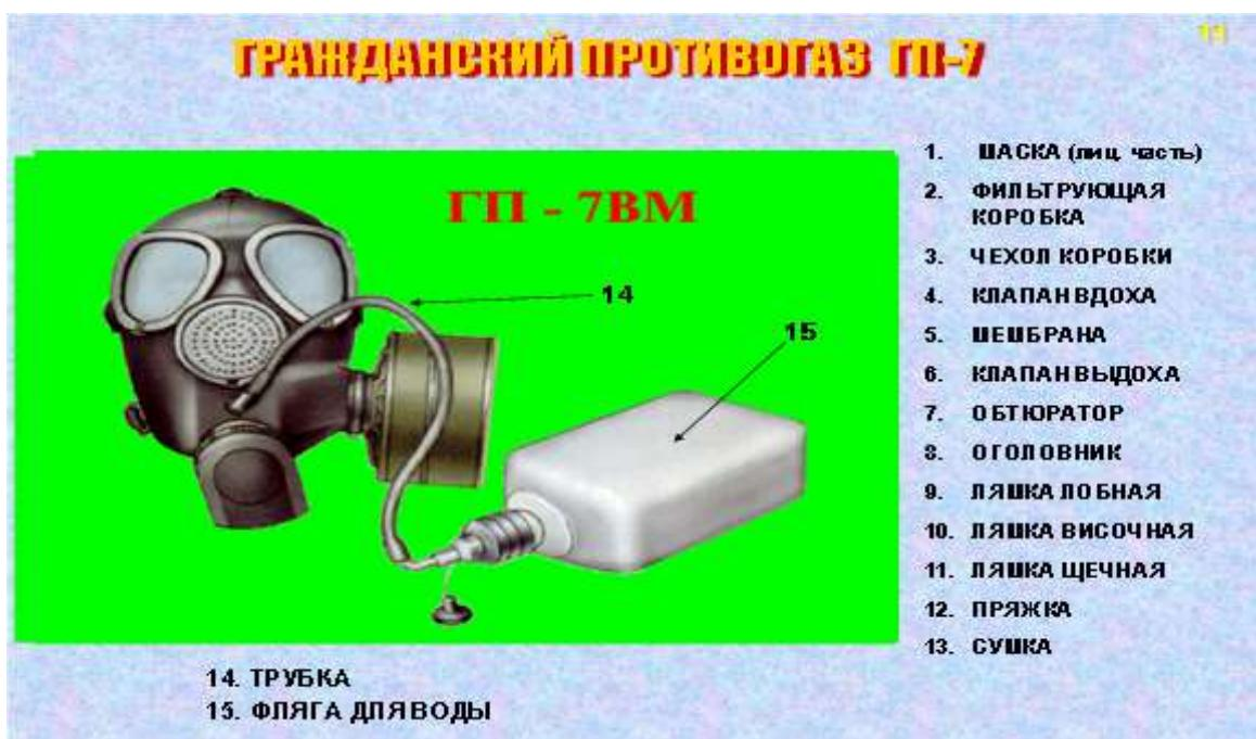
Фильтрующий противогаз ГП-7 состоит из фильтрующе-поглощающей коробки ГП-7к, лицевой части МГП, незапотевающих пленок (10 шт.), утеплительных манжет, защитного трикотажного чехла и сумки. Вес противогаза в сборе – 900 г.
